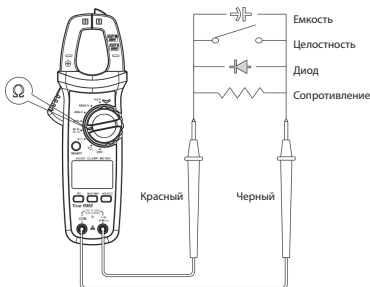
Рис 4. Проверка целостности, измерение сопротивления, проверка диода, измерение емкости
