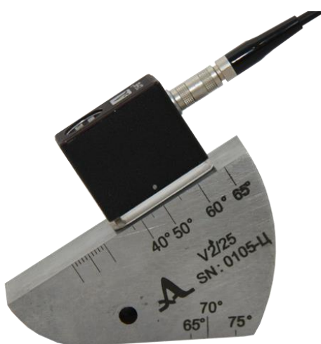
Угол калибруемого ПЭП меньше или равен 62^\circ
