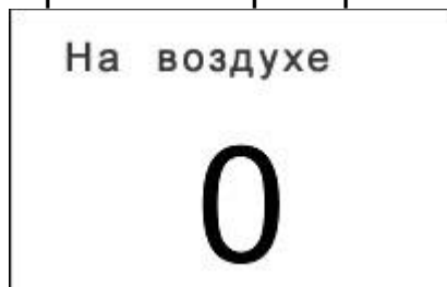
Рис. 2-2 Вид экрана прибора в режиме калибровки собственных шумов преобразователя
