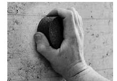
2.2.2. Шероховатость поверхности бетона на участке испытаний должна быть не более  $R_a=40 \text{ мкм}$ , что соответствует шероховатости поверхности бетонных кубов, испытанных при калибровке прибора. При необходимости для зачистки используйте шлифовальный камень из комплектации молотка-склерометра с последующей очисткой поверхности от пыли.
