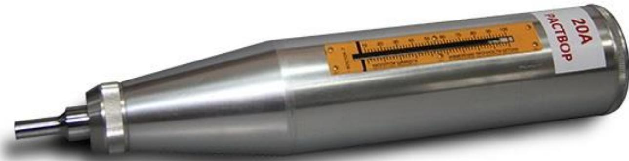
6.8. Измерение прочности раствора в кирпичной кладке прибором модели 20А (дополнительно к условиям для модели 225А).
