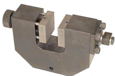
Гидравлический тисочный захват ПТГ-60 (60 кН)
