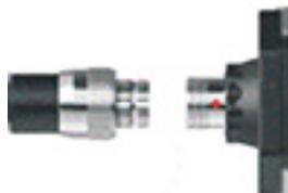
Совместите красный маркер разъема базового блока с выемкой разъема зонда и соедините разъемы. Затем закрутите фиксирующее кольцо.
