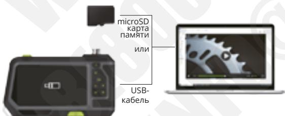
Вы можете использовать разъем для чтения карт памяти microSD для непосредственного копирования фото- и видеофайлов или использовать USB-кабель для копирования фото- и видеофайлов, не извлекая microSD карты памяти из разъема базового блока.
